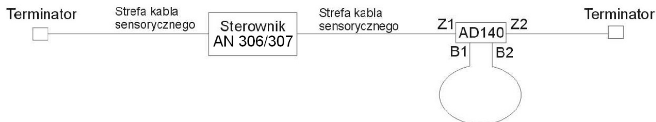
Rysunek 3. Schemat montażu modułu AD140:
