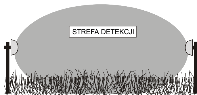
Rysunek 12 – Interferencje w strefie detekcji spowodowane wysoką trawą.
